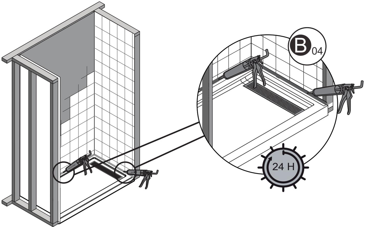
Pour les modèles avec les extrusions murales, si votre porte de douche doit être installée sur des carreaux de céramique, les tuiles doivent couvrir complètement le dessous des extrusions murales.
