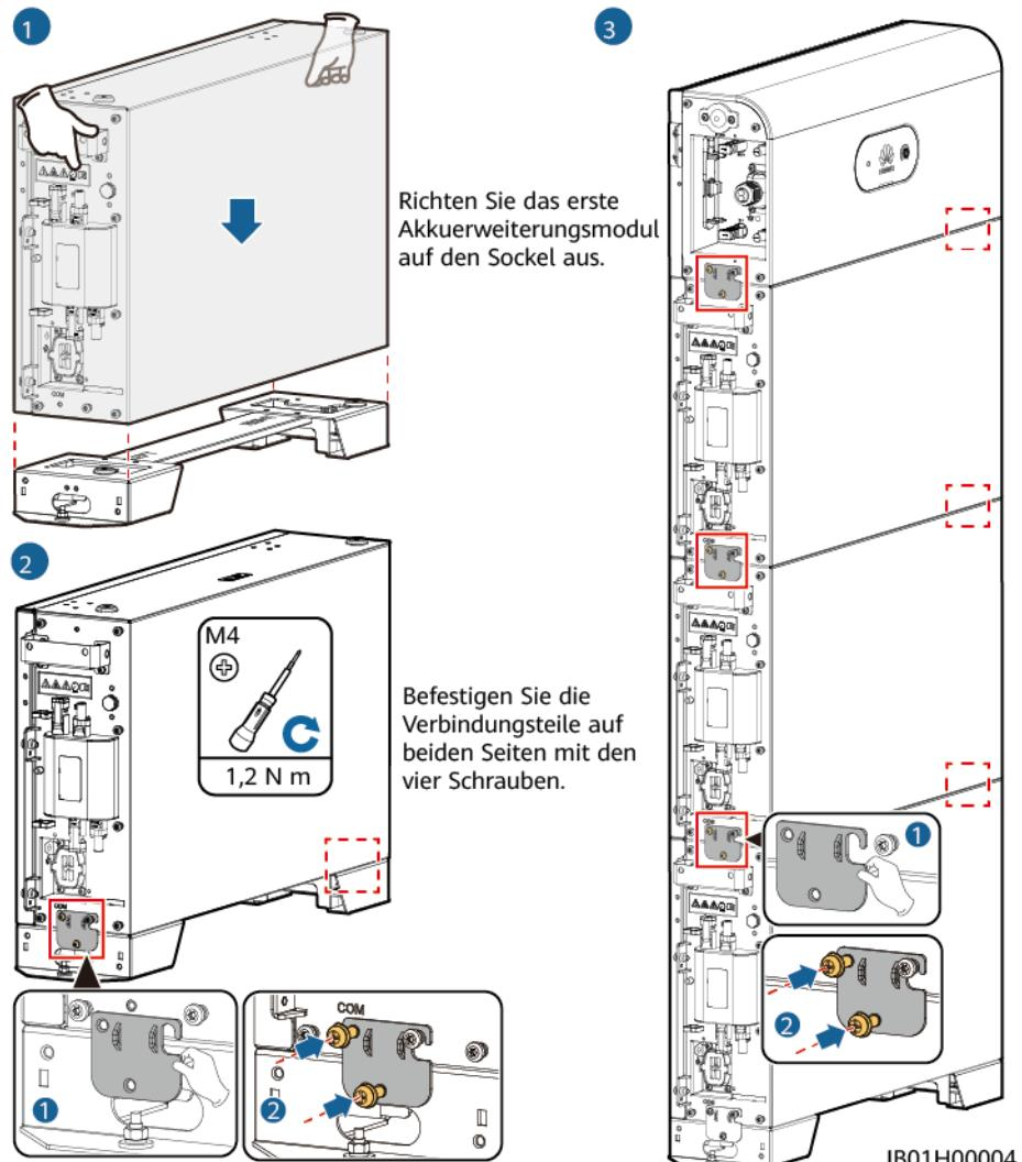
Montieren Sie von unten nach oben die restlichen Akkuerweiterungsmodule und das Leistungssteuermodul. Befestigen Sie nach der Montage eines Moduls die beiden seitlichen Verbindungsteile, bevor Sie das nächste Modul montieren.
