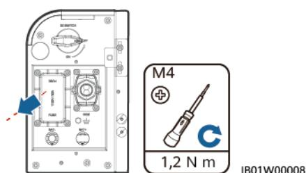
**Schritt 3** Heben Sie die Abdeckung des Sicherungskastens an, entfernen Sie die Sicherung, setzen Sie eine neue ein und schließen Sie den Sicherungskasten wieder. Wenn Sie ein Klickgeräusch hören und die Wölbung an der Seite sich innerhalb des Kastens befindet, ist der Sicherungskasten ordnungsgemäß installiert.
