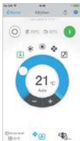
Řízení provozního režimu, teploty, čištění vzduchu, otáček ventilátoru a směru proudění
