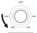
ADJUSTMENT RANGE FOR OUTER BURNER OPERATION-WOK BURNER
