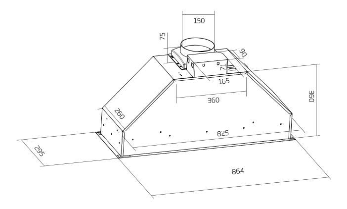
Model: HN-9UM/HN-9UMB Feeding Voltage: 220-240V 50Hz
