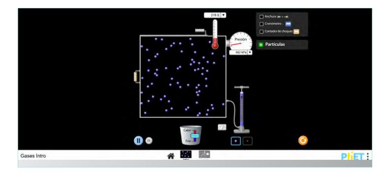
El modelo PhET es gratuito y le permite cambiar la presión de un gas en una caja. Este es un excelente uso de un modelo de partículas. Concéntrese en cambiar el volumen: ¿Qué pasa con la densidad? ¿Qué pasaría con el aire en un globo si se sumergiera más profundamente bajo el agua? El volumen del globo disminuye porque la presión en el exterior está aumentando. Esto hace que la densidad aumente. Este cambio se puede usar para operar un mecanismo.
