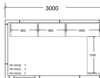
Mini chambres froides standard: sol zingué-plastifié anti-dérapant; résistance anti-buée sur la porte; soupape de décompression. Le périmètre extérieur du sol de la chambre froide est en acier inox AISI304
