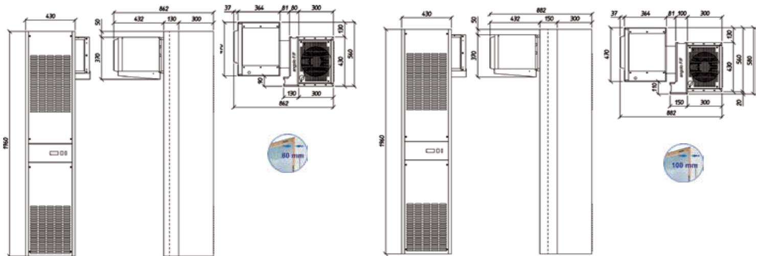
Unità refrigerante per minicella H 236/240 cm - Cooling unit for walk-in 236/240 cm H. - Unité réfrigérante pour la mini-chambre H 236/240 cm
