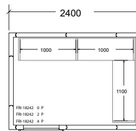
Minicella standard: Pavimento Zinco-plastificato antiscivolo; Resistenza anticondensa sulla porta; Valvola di compensazione. La zoccolatura esterna della Base della cella è realizzata in acciaio inox AISI 304.
