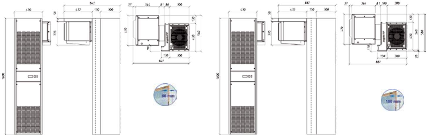
Unità refrigerante per minicella H 216/220 cm - Cooling unit for walk-in 216/220 cm H. - Unité réfrigérante pour la mini-chambre H 216/220 cm
