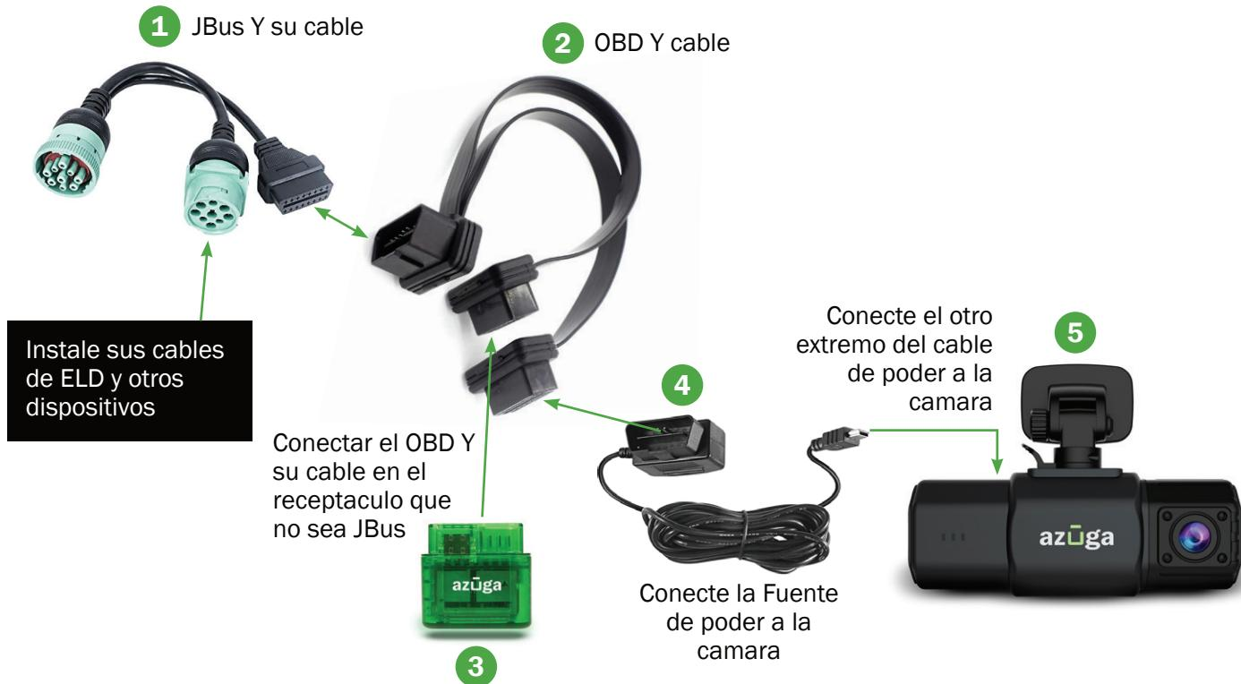
**Nota:** algunos vehículos como el de Volvo después de 2014 usan un puerto de diagnóstico de 16 pines. Si ese es el caso, se le proporcionarán 2 cables OBD Y. Utilice el cable OBD Y adicional como lo haría con el cable Y de Jbus en la caja 1.
