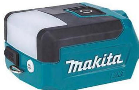
Kompaktní a lehká svítilna s možností bočního nebo horního svícení • Svítilna je vhodná pro použití se všemi akumulátoru Li-ion 14,4/18 V LXT • Maximální svítivost je 300 lm (obě) / 150 lm (čelní nebo horní LED) • Až 49/28 hodin svícení s akumulátorem BL1860B • Možnost nabíjení externího přístroje přes USB 5 V / 2,4 A • Automatické vypnutí svítilny v případě 30 minutové nečinnosti
