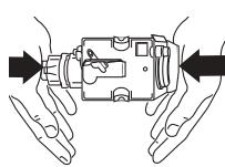
Если трудно вставить заварочный узел, необходимо (передвиганием) исправить его размер, нажав на два рычага, как показано на рисунке.
