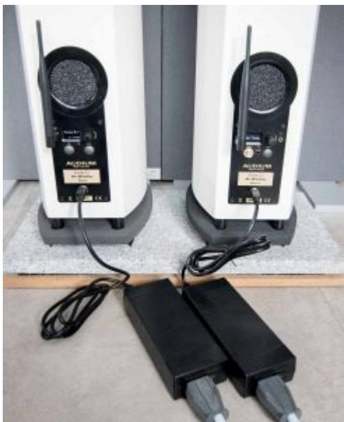
Cette paire d'Audium Comp 5.2 AIR était déjà configurée et les enceintes étaient marquées gauche et droite. Je les ai donc installés directement comme ça et j'ai vissé les antennes. La position des enceintes peut être réglée via le menu situé sur la borne arrière des enceintes. Le rôle du maître et de l'esclave est techniquement prédéfini.
