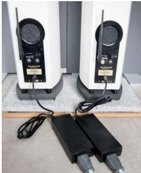
Questa coppia di Audium Comp 5.2 AIR era già impostata e gli altoparlanti erano contrassegnati a destra e a sinistra. Così li ho sistemati direttamente così e ho avvitato le antenne. La posizione degli altoparlanti può essere regolata tramite il menu sul terminale posteriore degli altoparlanti. Il ruolo del master e dello slave è tecnicamente predefinito.
