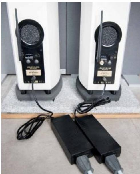
Dieses Paar Audium Comp 5.2 AIR war schon soweit eingerichtet und die Lautsprecher mit links und rechts gekennzeichnet. Also stellte ich sie auch direkt so auf und schraubte dabei die Antennen an. Die Lautsprecher-Position kann aber über das Menü am rückseitigen Terminal der Lautsprecher eingestellt werden. Die Rolle des Master und des Slave ist dabei technisch vorgegeben.
