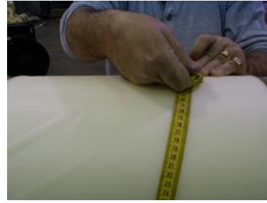
Figura 4: Medida incorrecta debido a que la cinta no está paralela al borde del rollo.
