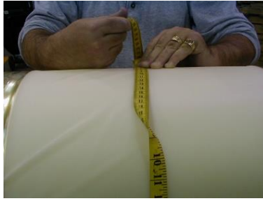
Figura 4: Medida incorrecta debido a entorchamiento de la cinta.
