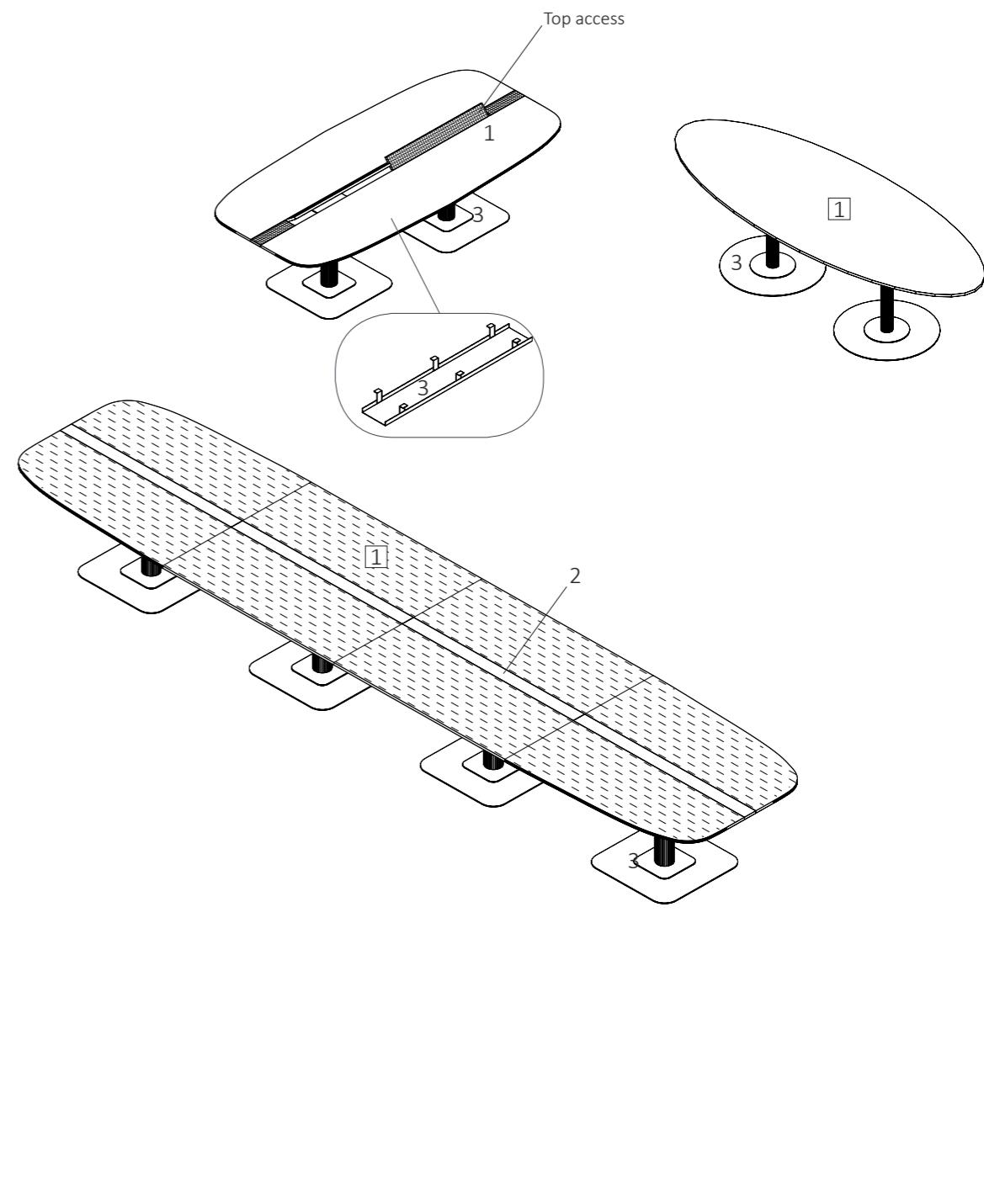
**1** - Piano scrivania**1** - Desktop**1** - Plateau du bureau**2** - Inserto centrale**2** - Central insert**2** - Insert central**3** - Gamba metallica, vaschetta portacavi e finiture elementi in metallo**3** - Metal leg, container for cables and finishes for metal element**3** - Pied en métal, conteneur porte-câbles et finitions disponibles pour éléments en métal<sup>(1)</sup> Effetto Real Touch tridimensionale / 3D Real Touch Effect / Effet Real Touch Tridimensionnel
